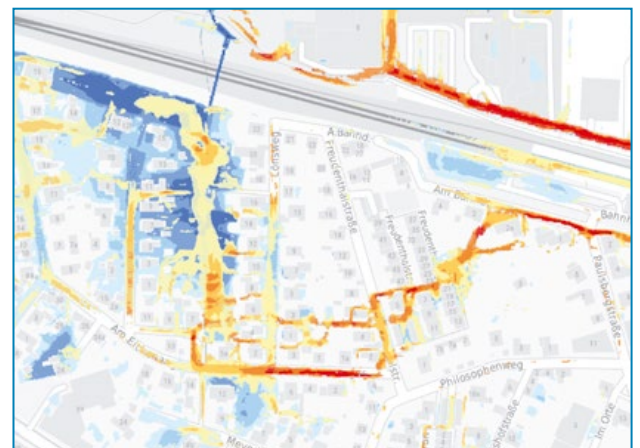
Abb. 35.5 Überflutungstiefe und Fließgeschwindigkeiten des abfließenden Wassers im Ortsteil Achim bei extremem Starkregen
