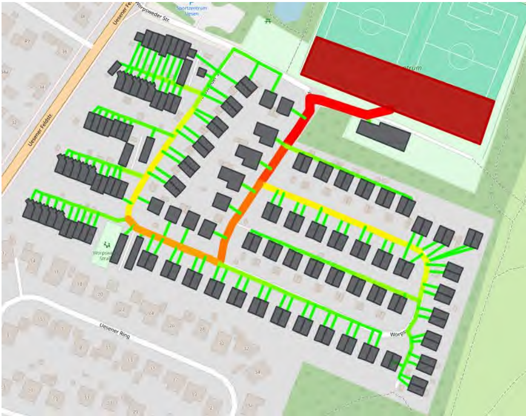
Abbildung 51: beispielhafter Trassenverlauf für ein kaltes Wärmenetz im Gebiet „Worpsweder Straße“; Quelle: beKS 2025
